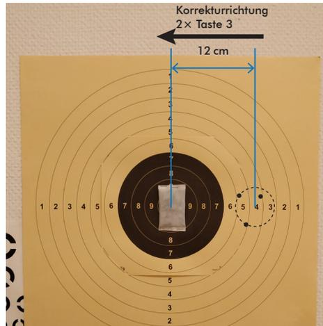
2. Liegt die Treffergruppe z.B. rechts neben dem Ziel, wird die rechte Taste (3) zur Korrektur betätigt. Liegt es zu hoch, wird die Taste nach unten (2) betätigt, um den Fehler zu korrigieren.
