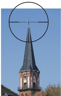
2. Befestigen Sie nun das Zielfernrohr in dieser Position, damit diese Ausrichtung in den nun folgenden Schritten beibehalten wird. Dies kann z.B. über einen Einschießbock erfolgen oder auch durch eine zweite Person, die das Zielfernrohr zuverlässig in Position hält.
